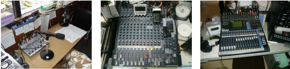
今回使用されたミキサー(簡易型、平均的機能、デジタル多機能の3例)
